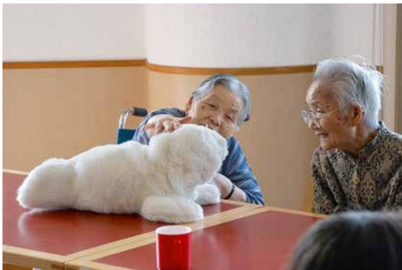
Die Plüsch-Robbe kann die Flossen bewegen und reagiert auf Streicheleinheiten mit einem freundlichen Blick sowie einem Schnurren. Der interaktive Roboter wird auch in Schweizer Seniorenzentren eingesetzt.
