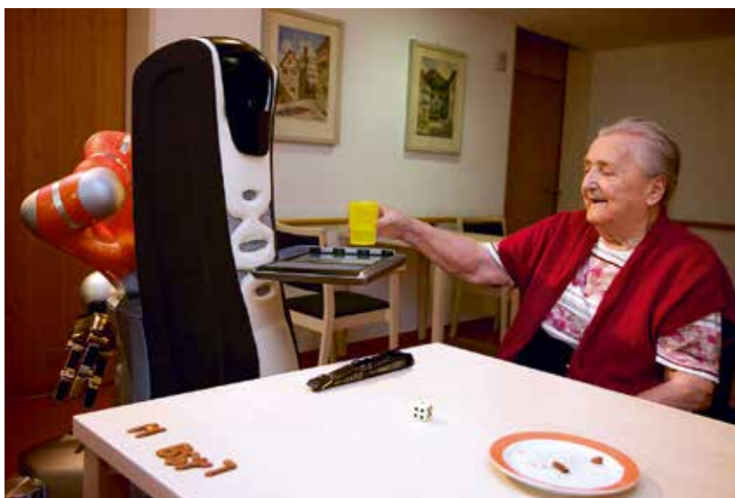
Roboter als Pflegeassistent: Wie ein Butler können sie Getränke servieren und dabei unterstützen, dass die älteren Menschen genügend Flüssigkeit zu sich nehmen. Dadurch werden Pflegefachkräfte in Heimen entlastet.
