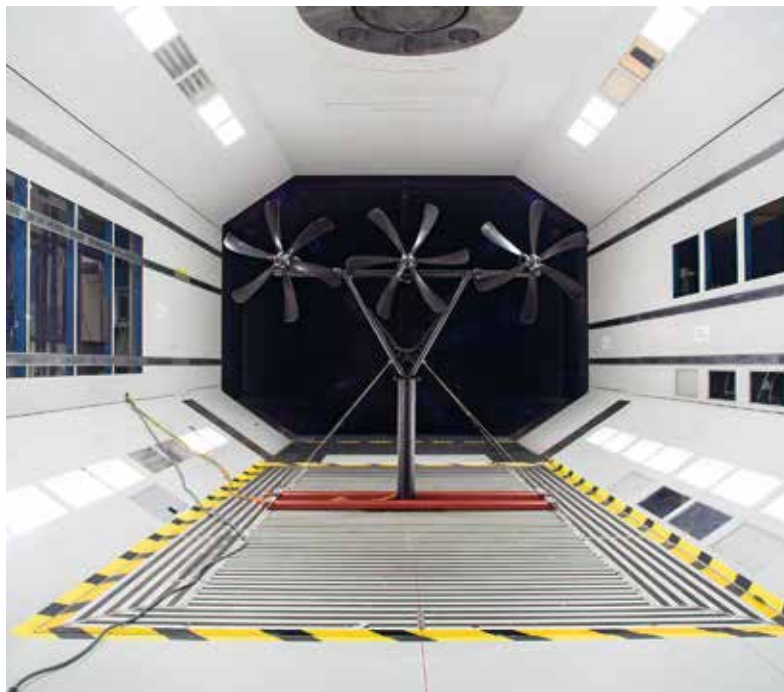
Die dreierotorige Windkraftanlage «Hans» hat eine installierte Leistung von 250 Kilowatt. Der Rotordurchmesser beträgt 14 Meter.
