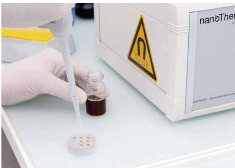
Hier wird eine Stichprobe von Nanopartikeln pipettiert als Vorbereitung für den Test, mit dem die richtige Dosierung bestimmt werden soll.
