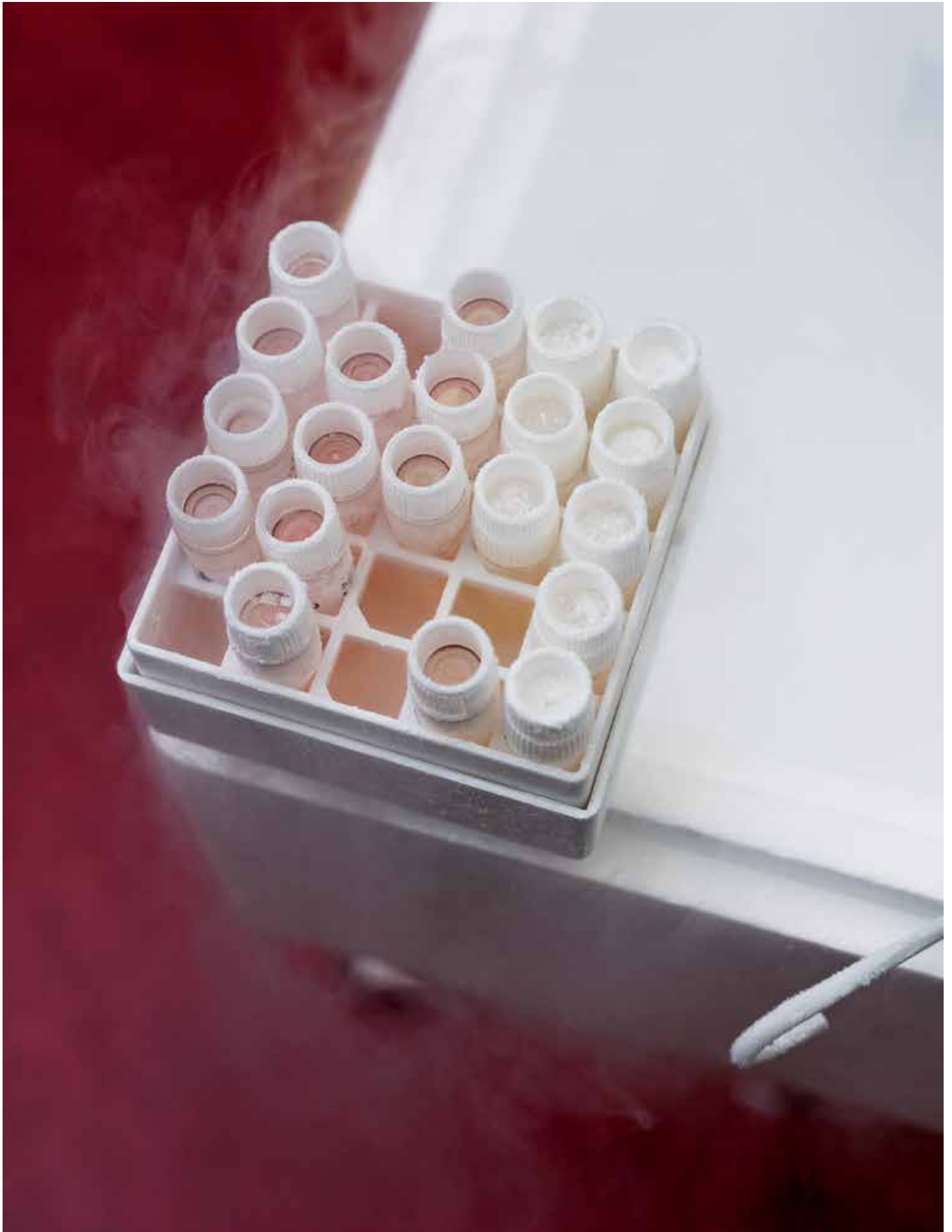
In den Gefriertanks der Fachgruppe Tissue Engineering lagern viele verschiedene menschliche Zellen in flüssigem Stickstoff. Bei minus 196 Grad können sie jahrelang aufbewahrt und für Versuche aufgetaut werden, etwa für Medikamententests.
